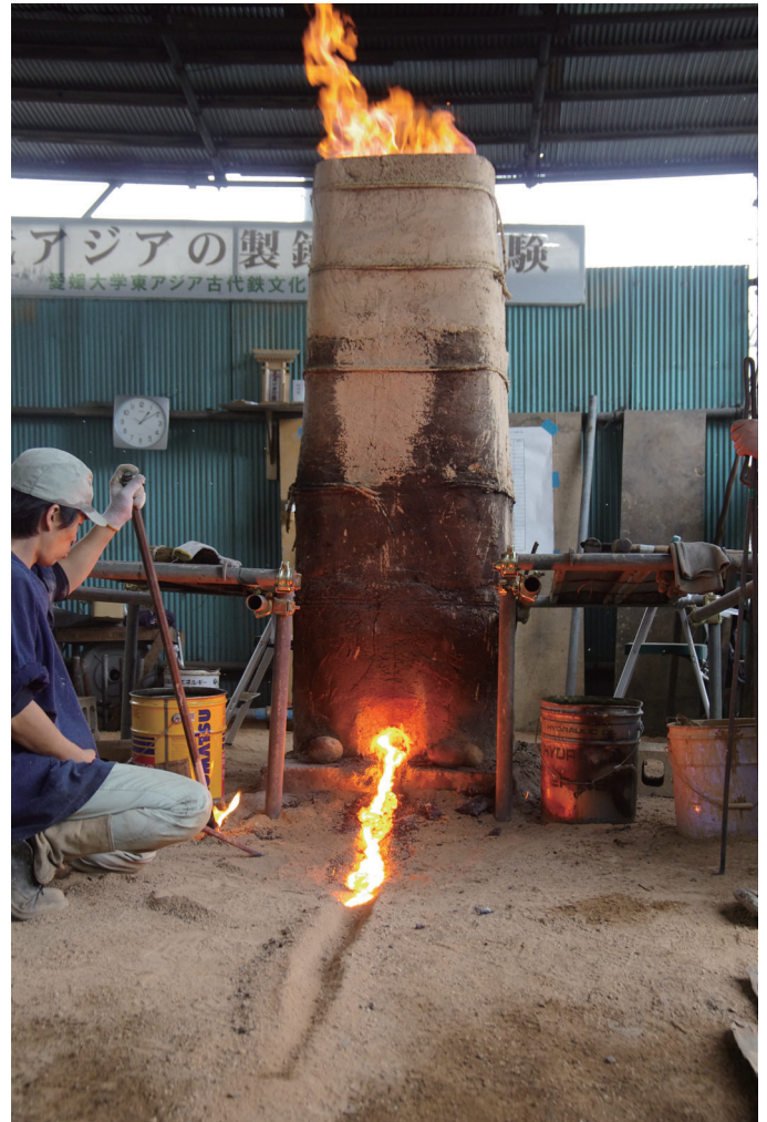
写真3. 今回操業した大陸式製鉄炉。
